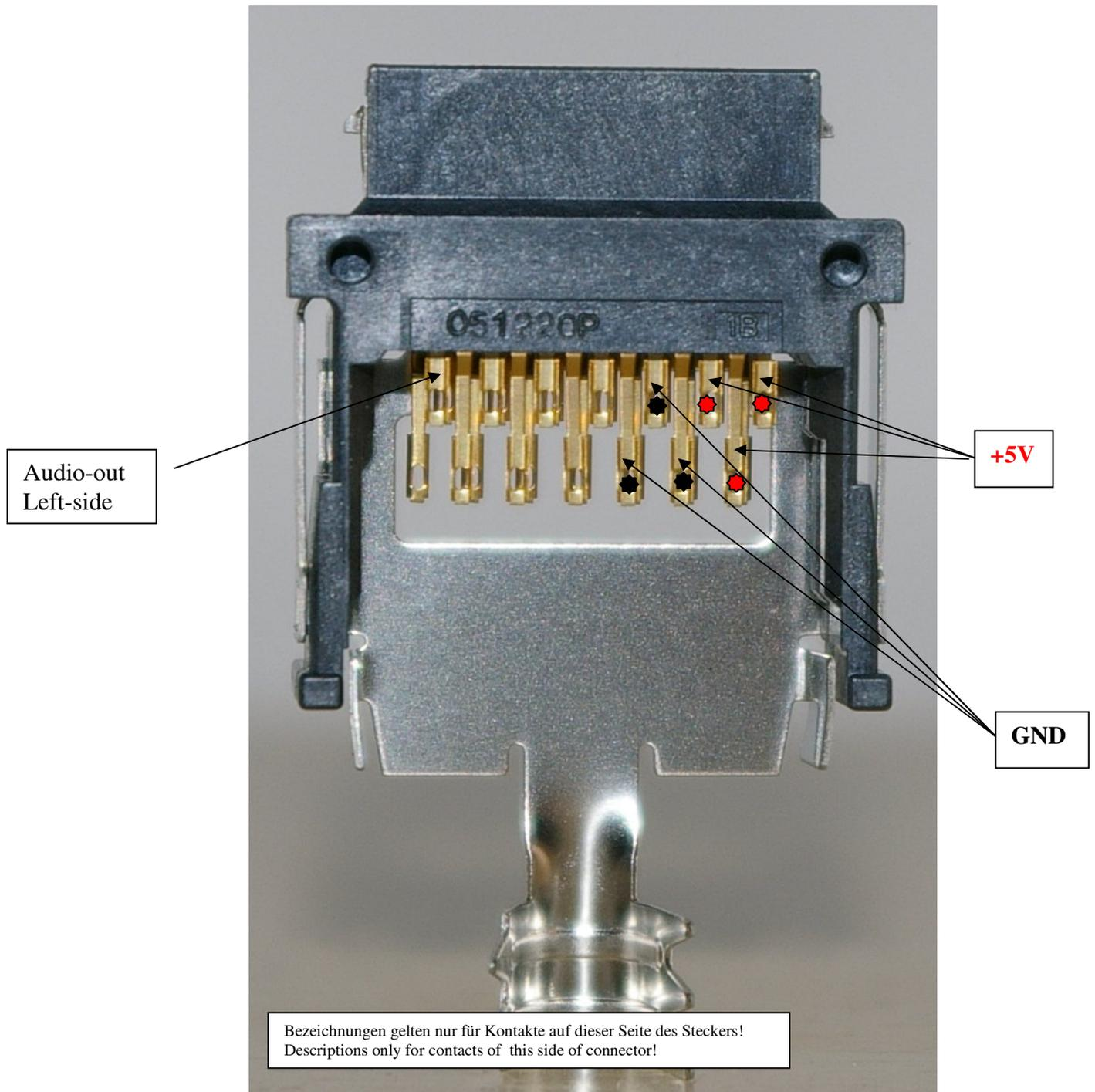
Tatung verwendet auf jeder Kontaktreihe des Steckers (2 Kontaktreihen) jeweils drei Kontakte für +5V und drei Kontakte für Masse. Das ergibt also insgesamt 6 Kontakte für +5V und 6 Kontakte für Masse. Das ist notwendig, um den hohen Ladestrom von bis zu 3A übertragen zu können.
